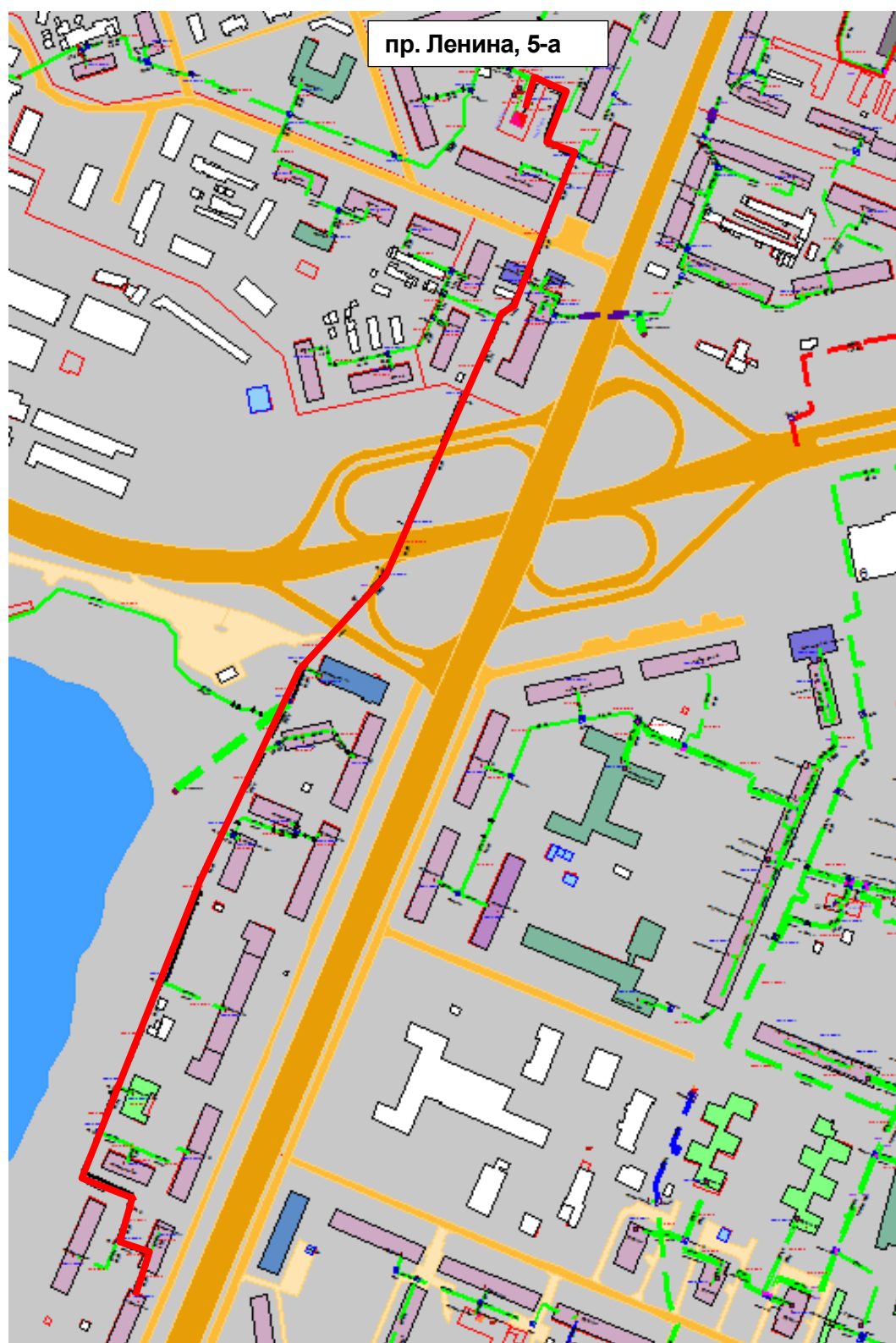
Рисунок Ошибка! Текст указанного стиля в документе отсутствует..187 – Результат гидравлического расчета - расчетный путь теплоносителя от котельной пр. Ленина, 5-а до ПТ-пр.Ленина,23
