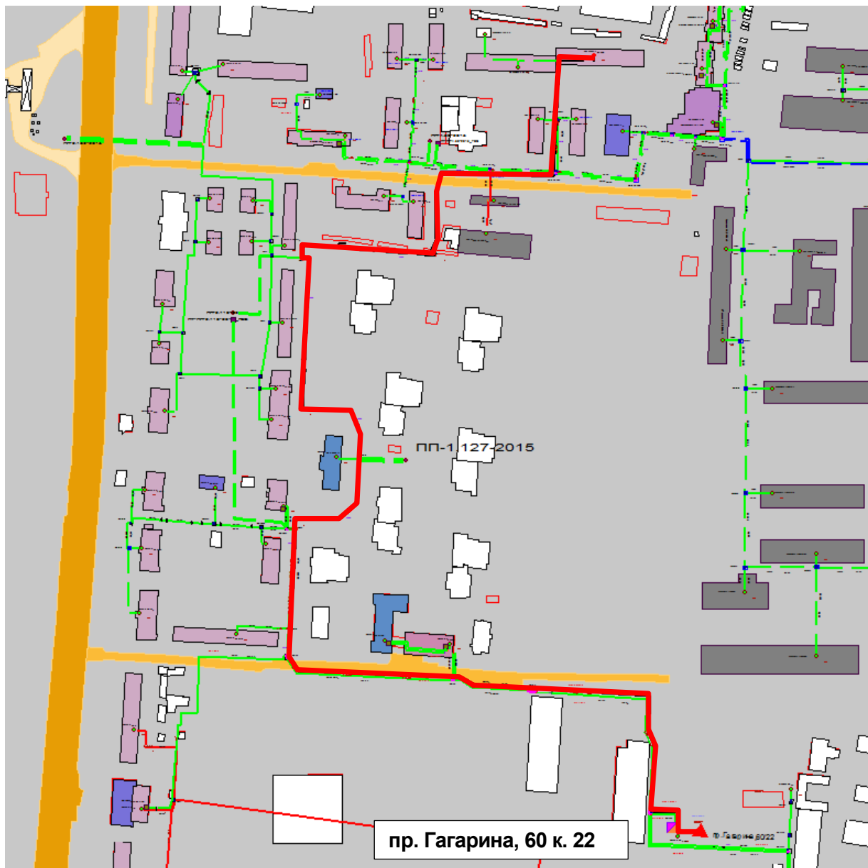
Рисунок Ошибка! Текст указанного стиля в документе отсутствует..171 – Результат гидравлического расчета - расчетный путь теплоносителя от котельной Гагарина, 60 к.22 до ПТ-Краснозв,12а вв2
